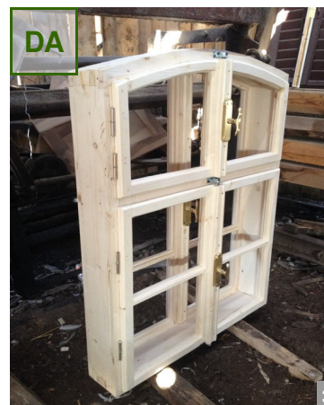
AȘA DA: Atunci când fereastra nu mai poate fi salvată, se poate recurge la serviciile unui atelier local de tâmplărie, pentru a o reproduce după croiul original.
