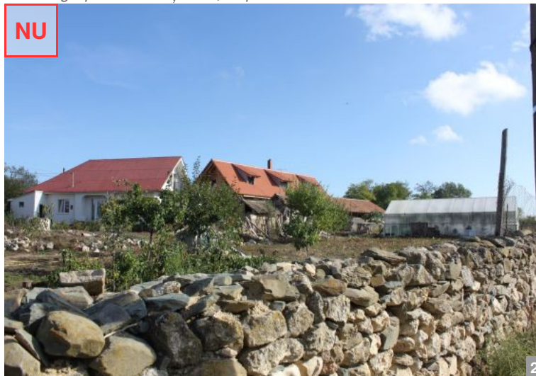
AȘA NU: Este total nerecomandată situarea pe același teren a două sau mai multor construcții (chiar dacă una este veche, renovată) la care se folosesc materiale de închidere, finisaje și culori nearmonizate. De asemenea, poziția lor una față de cealaltă este în contradicție cu gospodăria tradițională și cu un mod de viață confortabil.
