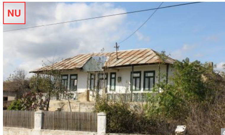
AȘA NU: Încercare nereușită de modificare a volumetriei acoperișului prin crearea unui fronton în axul construcției, dar cu modificarea echipartiției stâlpilor și introducerea unui material nou total nepotrivit.
