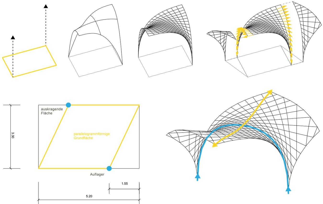
Der Design Carport ist ein Prototyp für Innovation in der Erforschung digitaler Entwurfs- und Fertigungstechnologien in der Metallverarbeitung. Tragverhalten, Materialeigenschaften und Konstruierbarkeit werden von Anfang an als Parameter in den Entwurfsprozess integriert, das Resultat ist eine expressive und effiziente Struktur.
